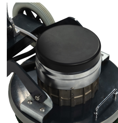
Motorschutzabdeckung schützt den Motor vor Feuchtigkeit.
