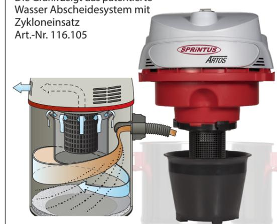
Durch den Drall am Einlassstutzen wird der Sprühnebel an der Behälterwand abgeschieden. Zusätzliche Filterstoffe sind nicht mehr notwendig. Die zuverlässige Schwimmerabschaltung reagiert selbst bei extremer Schaumbildung. Seitliche Kühl-Luftschlitze sorgen für konsequente Trennung von Kühl- und Prozessluft.
